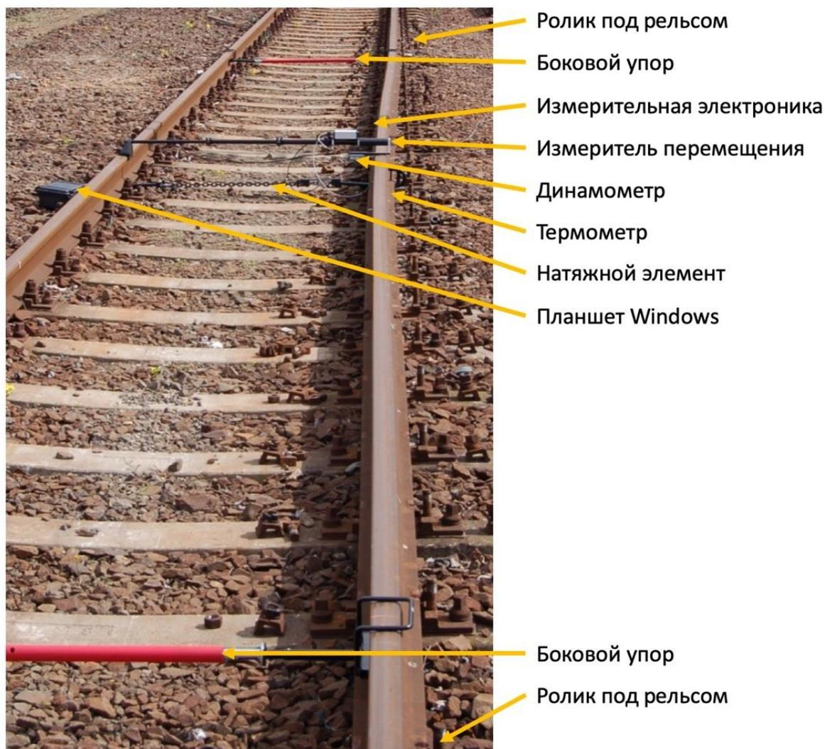
Рисунок 9. SidePull при поперечном смещении рельсовой нити
