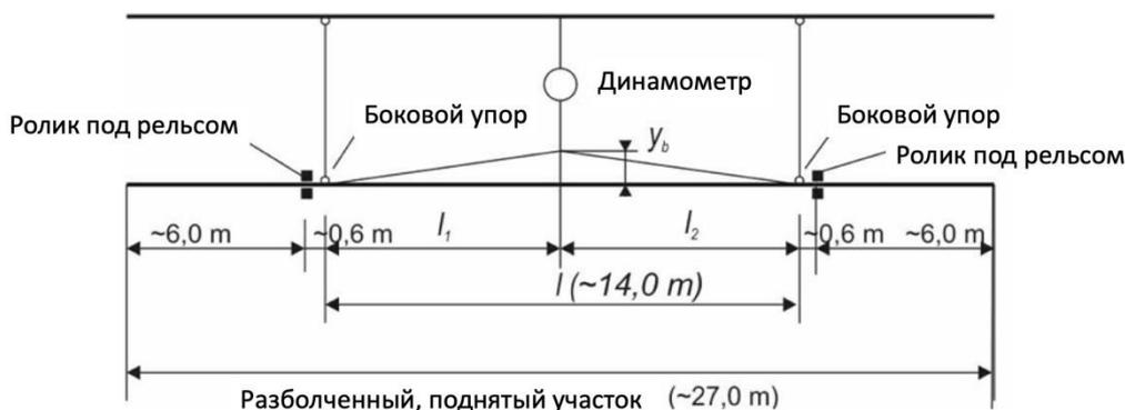
Рисунок 7. Схема измерения силы на практике
