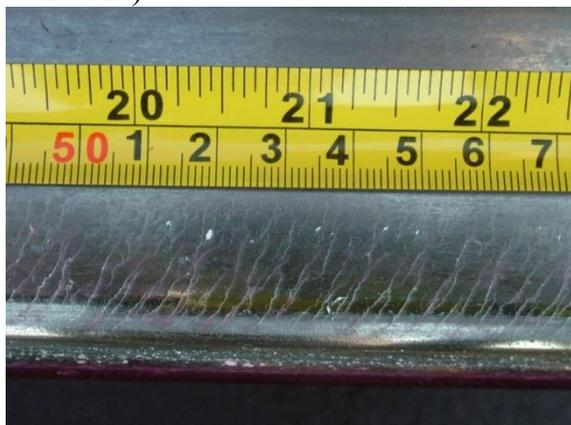
Рис. 4. Плотное расположение дефектов Head Checking
