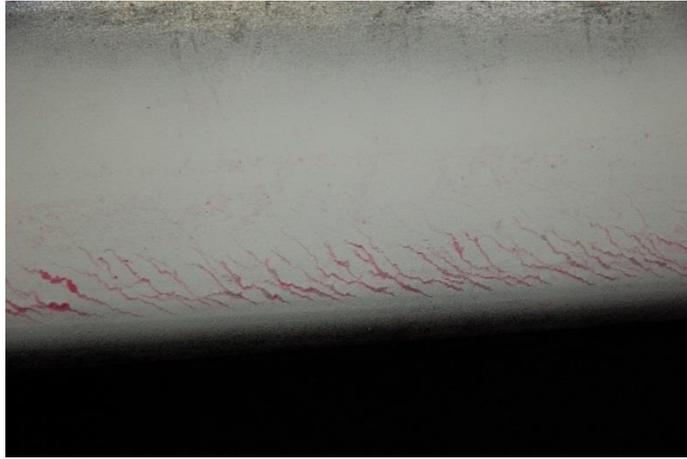
Рис. 18. Результат пенетрационного контроля микротрещин на поверхности рельса
