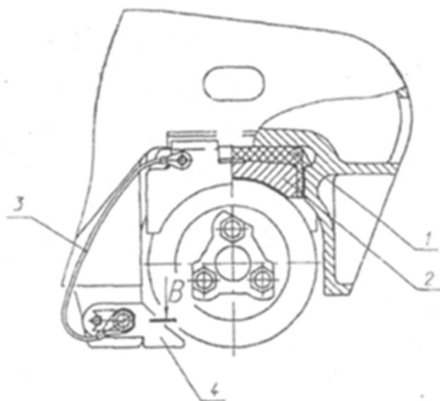
1 – вставка адаптера; 2 – адаптер; 3 – устройство отвода статического электричества; 4 – устройство исключающее выход колесной пары из буксового проема
