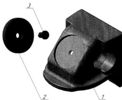
1 - фрикционный клин; 2 - полиуретановый вкладыш; 3 - полиуретановая ось вкладыша
