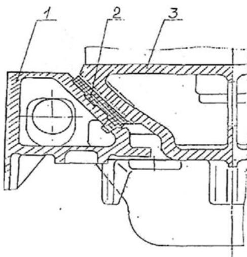
1 – фрикционный клин; 2 – полиуретановая накладка; 3 – надрессорная балка
