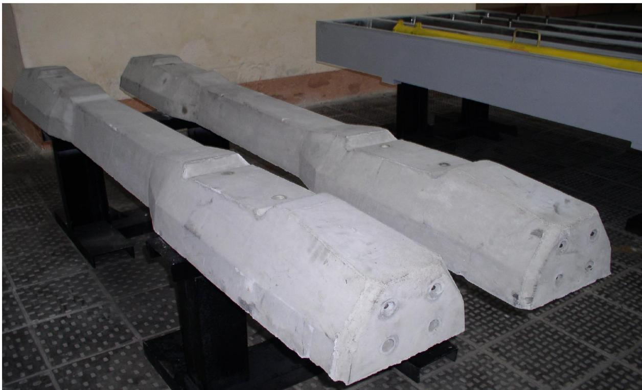
Рисунок 2. Общий вид шпалы, изготовленной по технологии в коротких формах на Челябинском заводе
