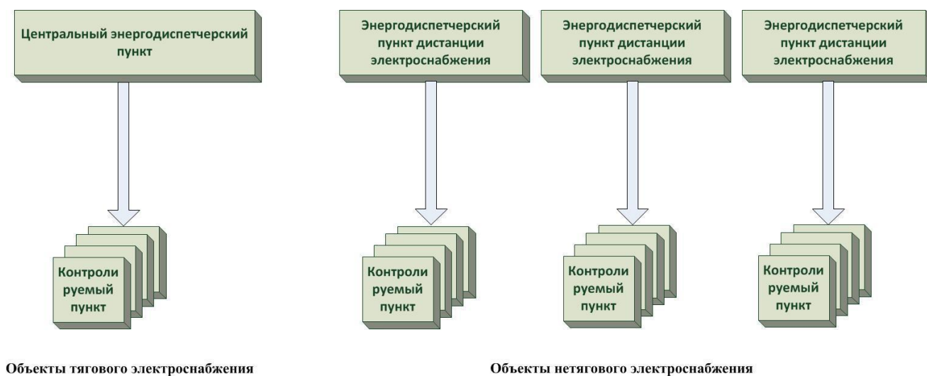
Рис.1. Структурная схема организации телемеханики по иерархическому принципу
