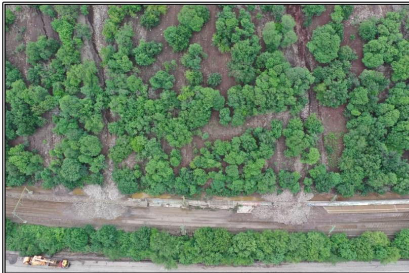
Места переваливания селевого потока через защитное ограждение железной дороги
