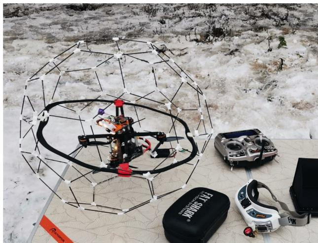
Защищенный дрон для обследования пролетных строений мостов
