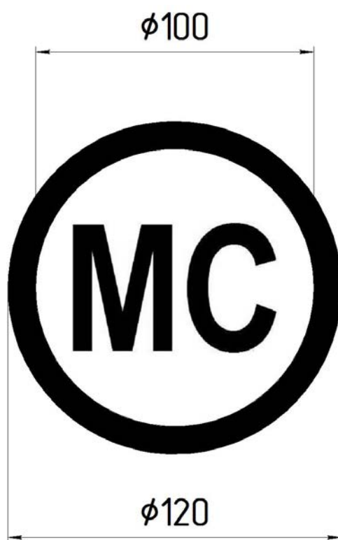
Рисунок 4 Обозначение соответствия габариту 03-ВМ
