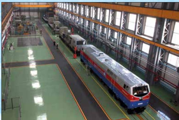
Lokomotivebaubetrieb für die Herstellung von TE-33A „Evolution“ Dieselloks in Kasachstan
