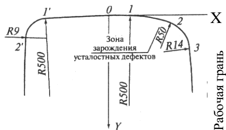
Рисунок 3. Ремонтный профиль рельсов с вертикальным износом (1-4) мм, когда пропущенный тоннаж от 150 до 500 млн.т брутто на прямых участках и в кривых более 1000 м
