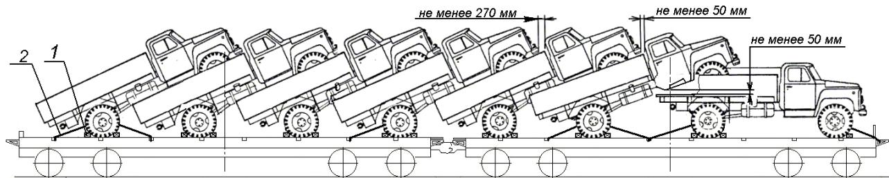
Рисунок 19 – Размещение и крепление автомобилей на сцепе платформ
