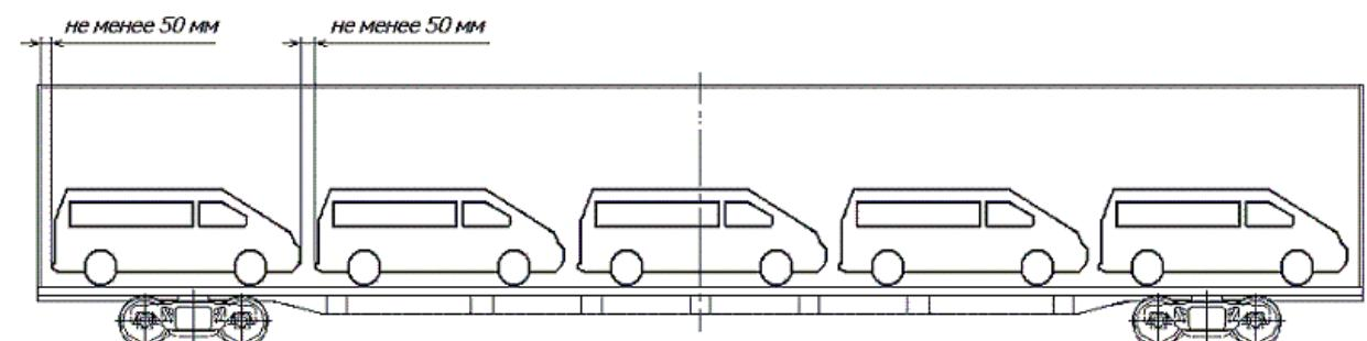
Рисунок 27 – Размещение автомобилей в вагоне в один ярус
