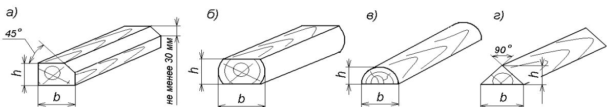
Рисунок 7 – Варианты исполнения упорных брусков для подклинивания обрезиненных колес из:
