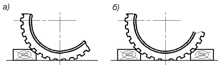
Рисунок 6 – Подклинивание обрезиненных колес техники
