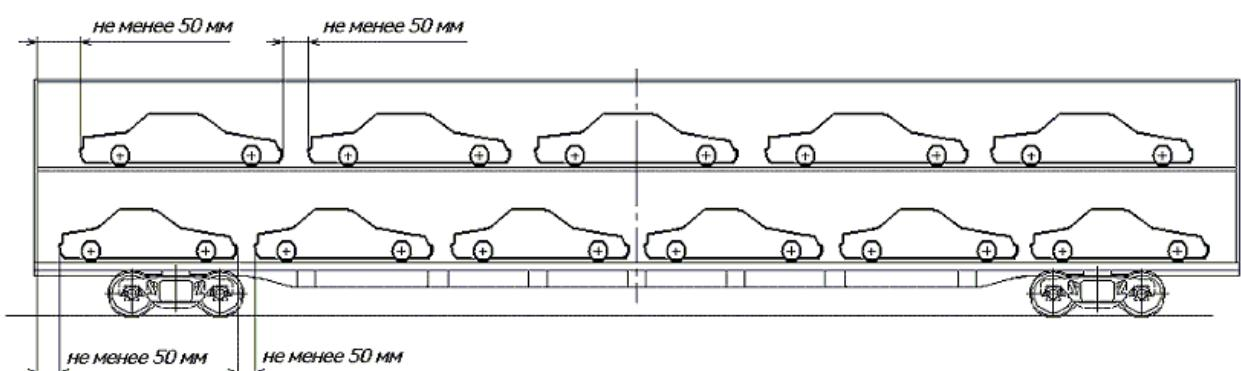
Рисунок 26 – Размещение автомобилей в вагоне в два яруса
