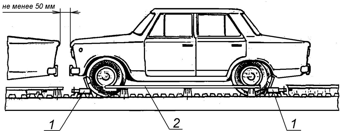
Рисунок 24 – Крепление автомобиля колесными упорами
