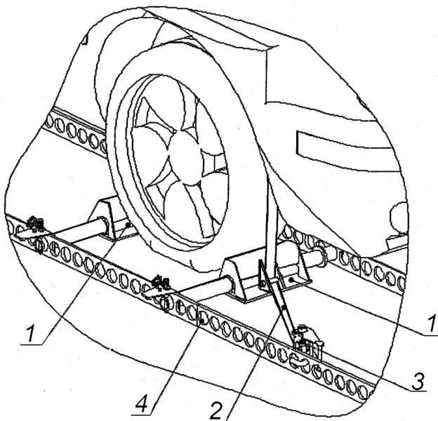
Рисунок 29 – Колесный упор с крепежным ремнем
