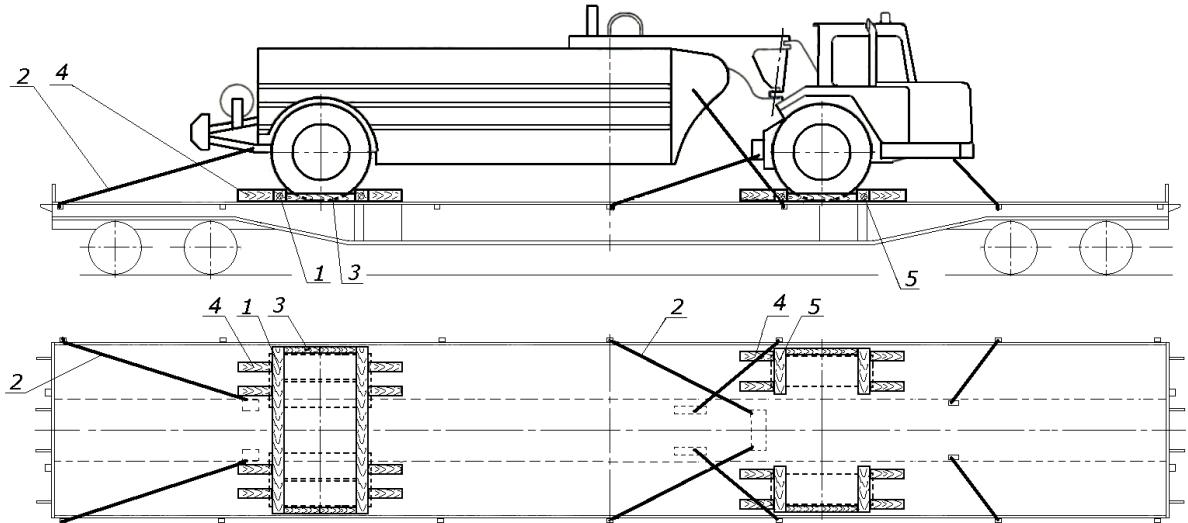
Рисунок 10 – Размещение и крепление на платформе техники с шасси сочлененного типа
