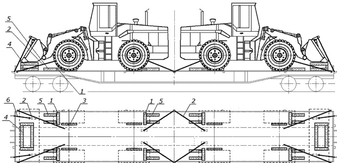
Рисунок 11 – Размещение и крепление на платформе техники с навесным оборудованием
