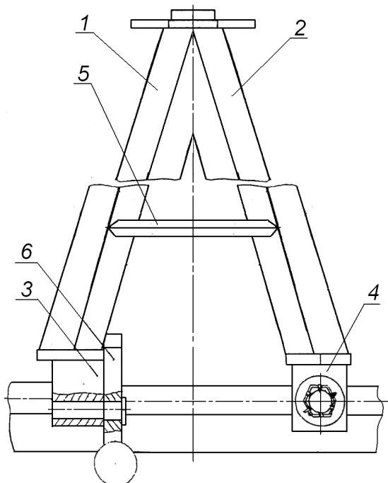
Рисунок 30 – Колёсный упор треугольной формы
