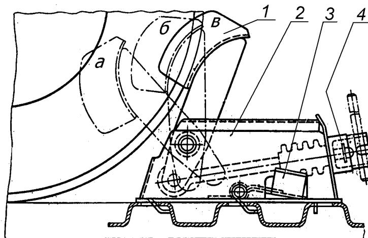
Рисунок 23 – Колесный упор
