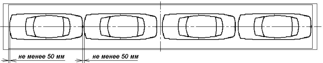
Рисунок 25 – Размещение автомобилей в один ряд
