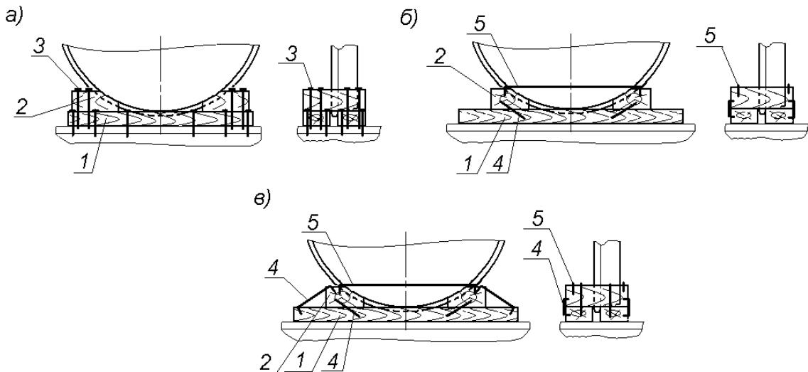
Рисунок 17 – Подклинивание металлических колес техники при нагрузке от колеса свыше 2,0 до 4,0 т включительно
