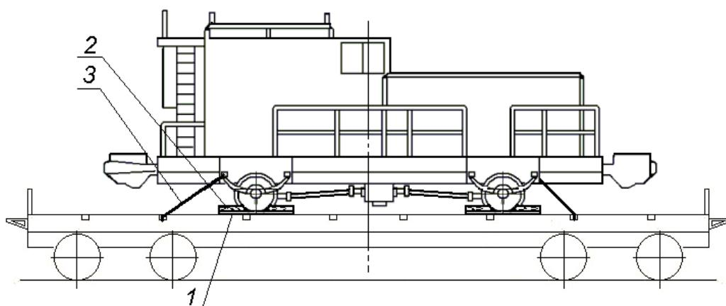
Рисунок 14 – Размещение и крепление техники
