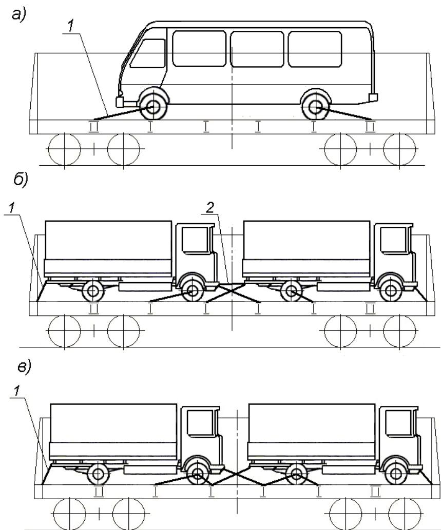
Рисунок 18 – Размещение и крепление техники на обрезиненных колесах
