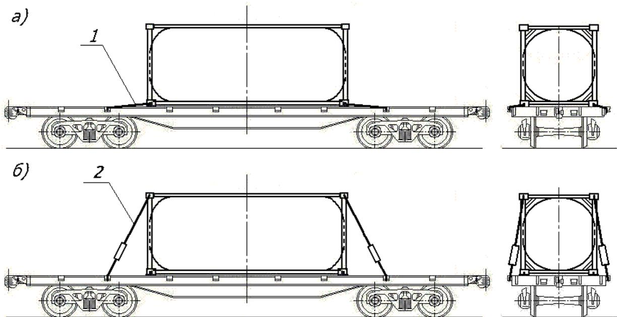
Рисунок 57 – Дополнительное крепление контейнера-цистерны на платформе базой 9720 мм:
