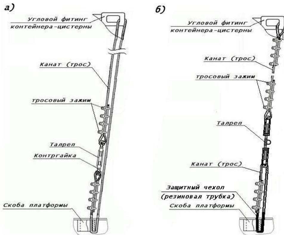
Рисунок б1 – Примеры установки тросовой растяжки крепления контейнера-цистерны:
