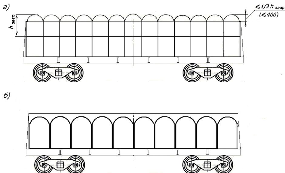
Рисунок 63 – Принципиальная схема размещения мягких контейнеров в полувагоне
