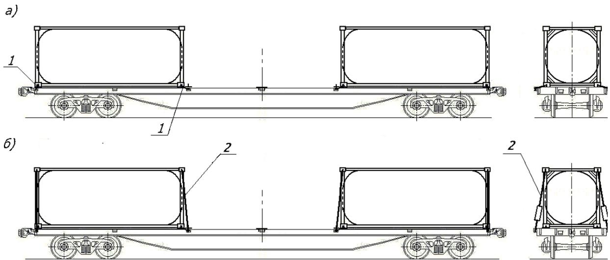
Рисунок 59 – Дополнительное крепление контейнеро-цистерн на платформе для крупнотоннажных контейнеров:
