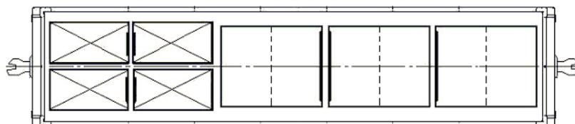
Рисунок 5 – Размещение контейнеров в контейнеровозе с торцевым ограждением в виде скоб или балок, закрепленных снаружи угловых стоек
