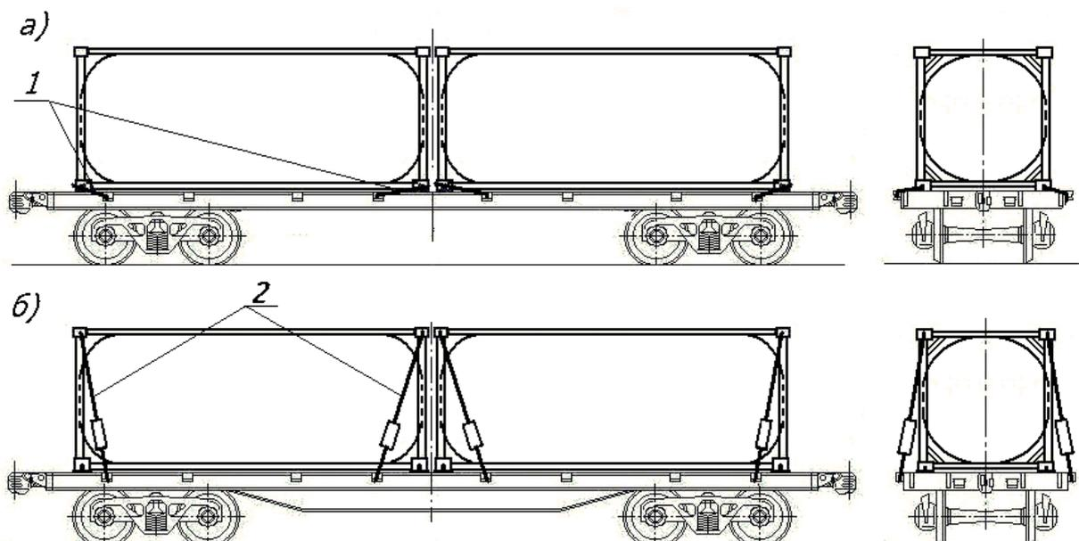
Рисунок 56 – Дополнительное крепление контейнеров-цистерн на платформе базой 9720 мм:
