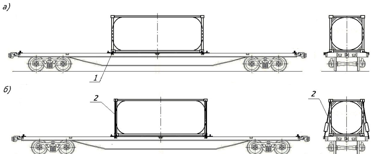
Рисунок 60 – Дополнительное крепление контейнера-цистерны на платформе для крупнотоннажных контейнеров:
