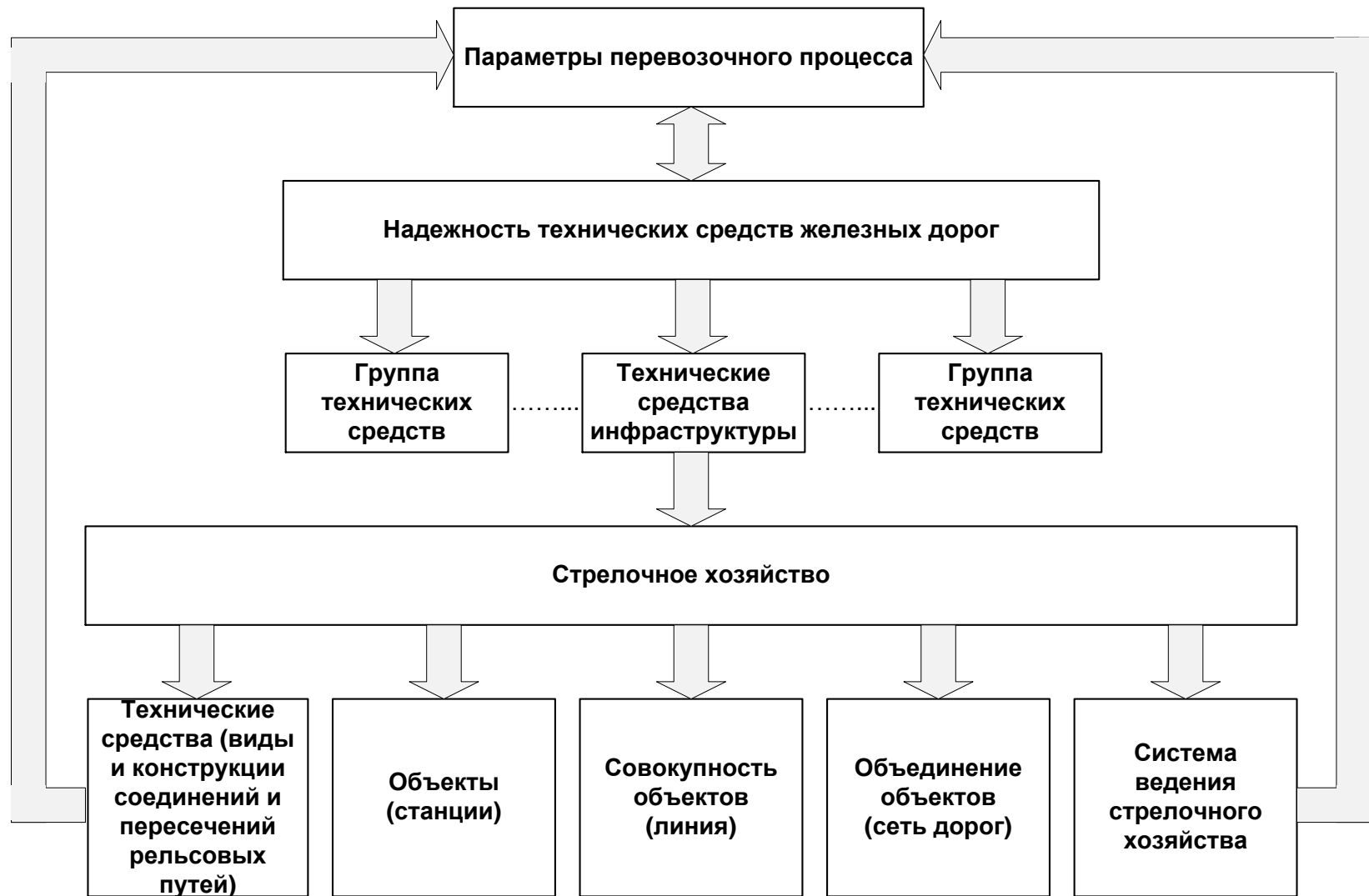
Рисунок 1 – Составляющие, обеспечивающие функционирование стрелочного хозяйства инфраструктуры
