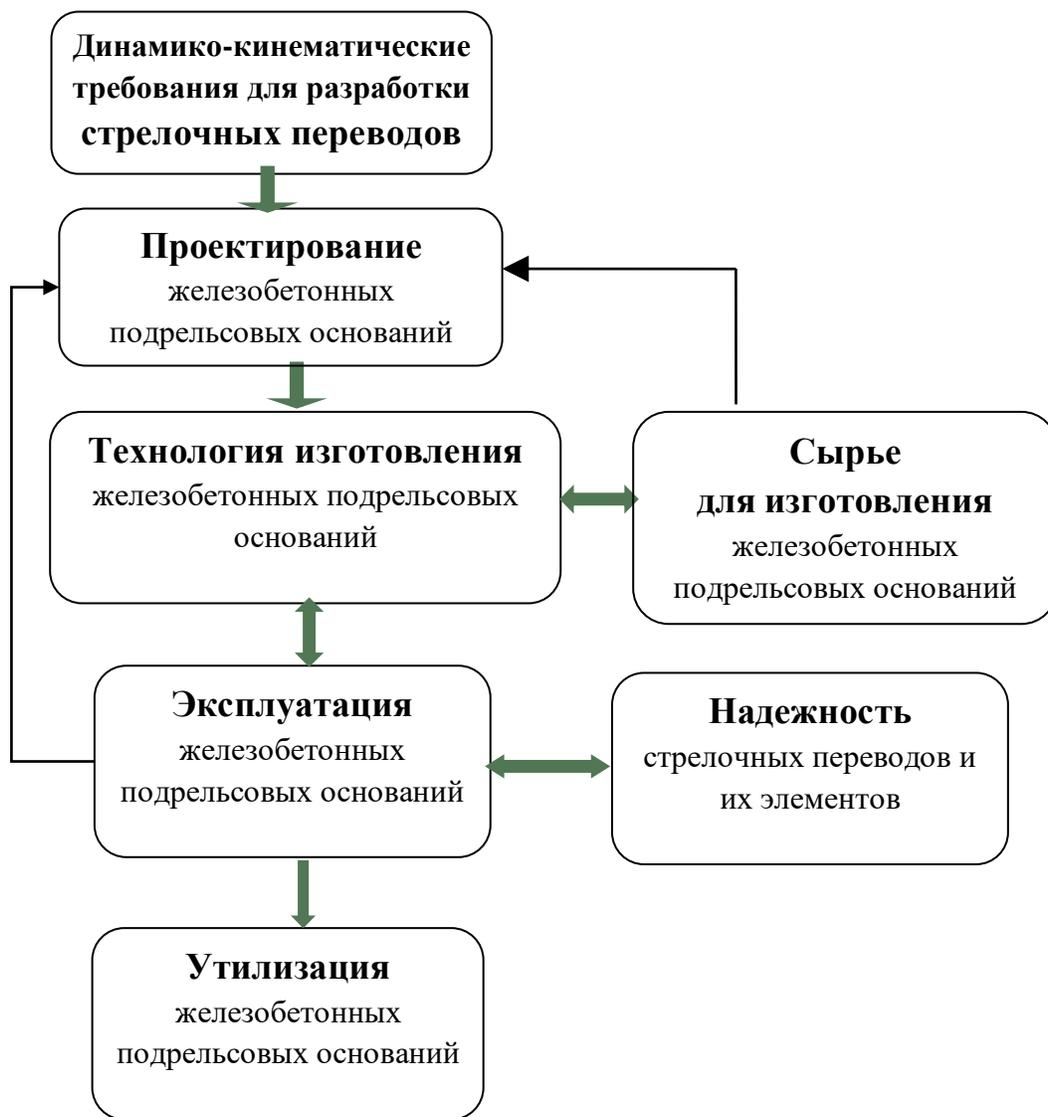
Рис. 2. Структура системы памятков железобетонных подрельсовых оснований
