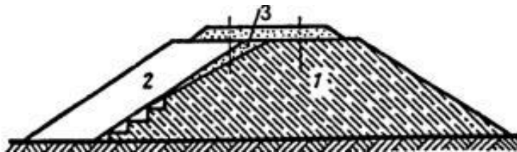
1 – насыпь первого пути; 2 – присыпаемая под второй путь часть насыпи; 3 – балластный шлейф старого земляного полотна
