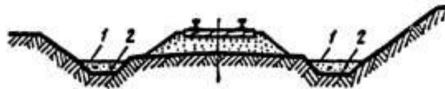
Рисунок 27. Заиливание кюветов и канав
