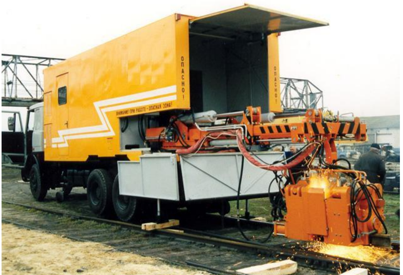
Фото 4 – Комплекс сварочный мобильный КСМ005 (комплекс размещается на базе автомобиля МАЗ36303 и имеет комбинированный ход для передвижения по железной дороге к месту работы)
