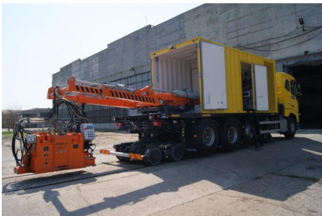
Фото 5 – Комплекс сварочный мобильный КСМ007 (комплекс выполнен на базе автомобиля VOLVO и имеет комбинированный ход для передвижения по железной дороге к месту работы)
