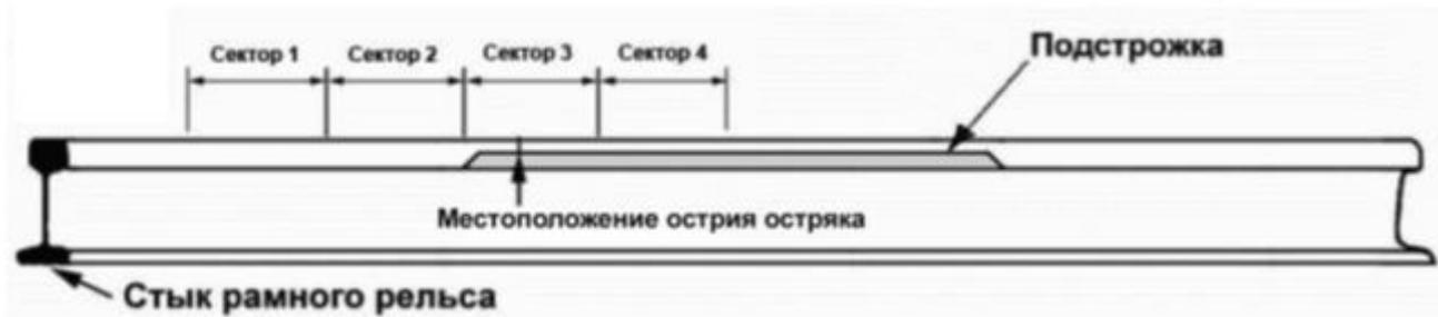
Рисунок 2. Деление участка зоны наплавки рамного рельса на сектора
