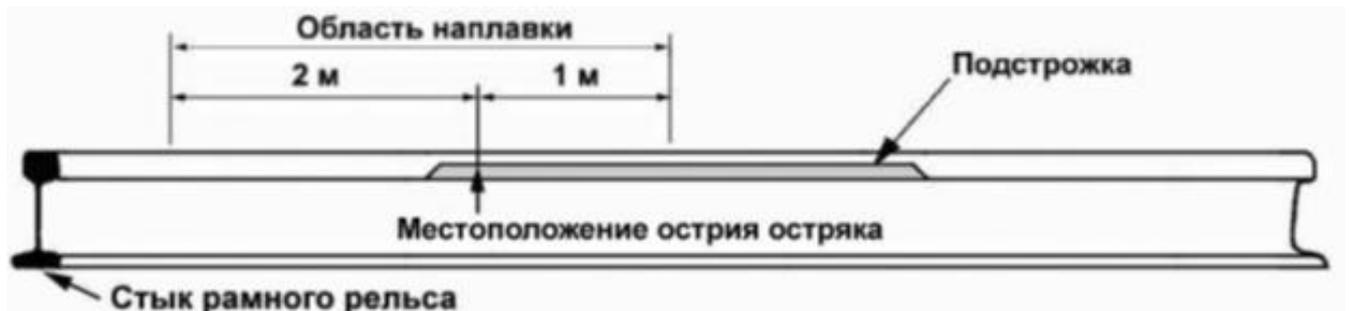
Рисунок 1. Разметка зоны участка наплавки рамного рельса
