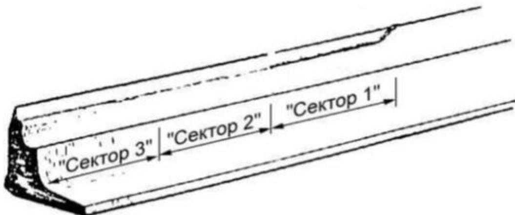
Рисунок 4. Разметка зоны наплавки острия секторами перед наплавкой по 30 см.
