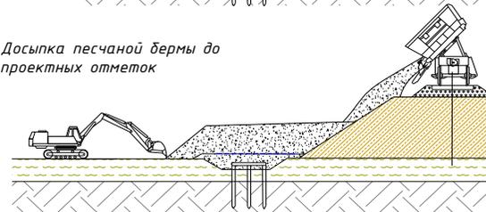
Опыт усиления земляного полотна также представлен грунтовыми или песчаными сваями. Песчаные сваи представляют собой вертикальные скважины, заполненные чистым крупным песком в оболочке из геотекстиля. Технология изготовления сваи заключается в том, что в стальную трубу, погруженную в грунт буровым или виброспособом, закладывают предварительно сформированный в виде рукава геотекстиль. Внутренний объем рукава заполняют песком. Затем производится извлечение трубы и уплотнение засыпанного песка.
