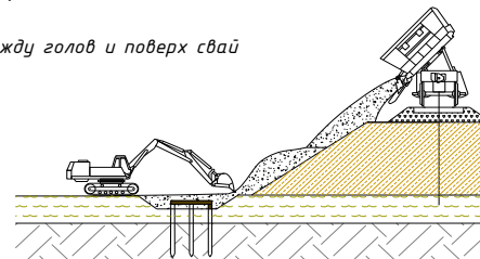
Технологическая схема устройства деревянных свай
