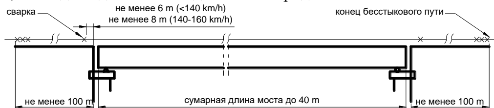
Рисунок 1. Схема закрепления бесстыкового пути на мостах без балласта со суммарной длиной несущих конструкции до 40 м
