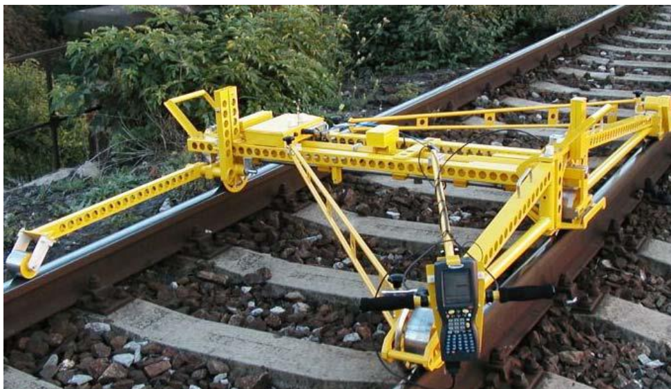
Рис. 2. Непрерывный метод измерения геометрических параметров по всей длине стрелочного перевода (вариант 2) а) измерительная тележка, б) оценка, отображение и печать результатов обработки измерений
