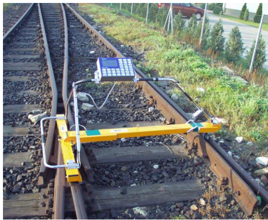
Рис. 1. Непрерывный метод измерения геометрических параметров по всей длине стрелочного перевода (вариант 1) а) измерительная тележка, б) оценка, отображение и печать результатов обработки измерений
