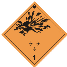
(№ 1) Подклассы 1.1, 1.2 и 1.3 Символ (взрывающаяся бомба): черный; фон: оранжевый; цифра "1" в нижнем углу
