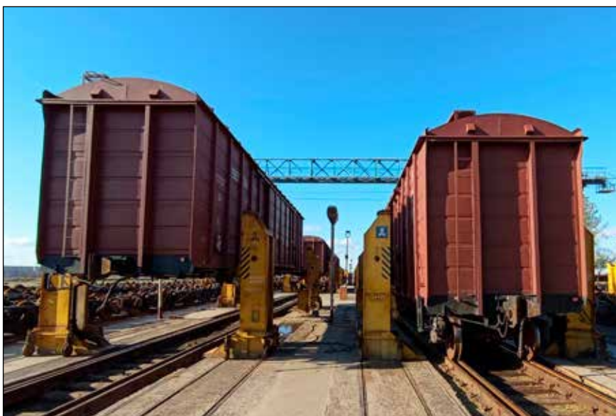
Пункт перестановки тележек между колеями 1520 мм/1435 мм на станции Сарахс на туркмено-иранской границе
