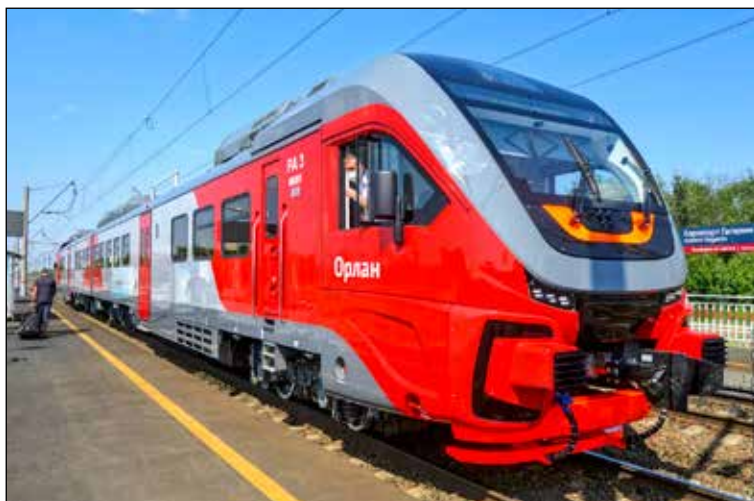
Водородный поезд для Сахалина разрабатывается на основе рельсового автобуса РА-3 «Орлан»
