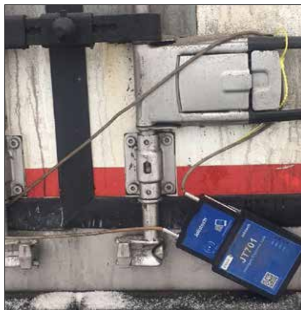
Электронная навигационная пломба – многоразовое средство идентификации на основе технологии ГЛОНАСС
