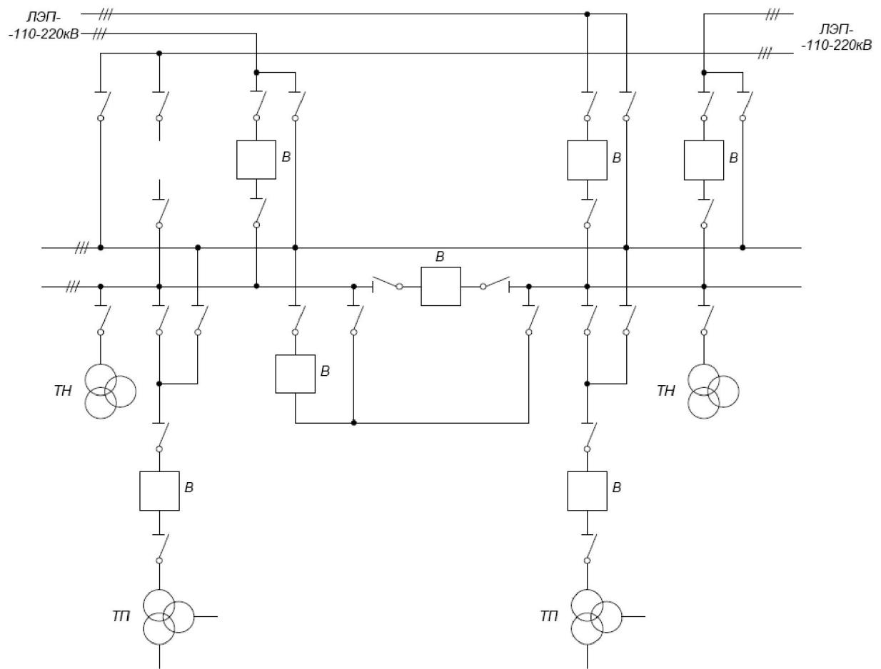
**Рис. 3 – Схема подключения опорной тяговой подстанции
