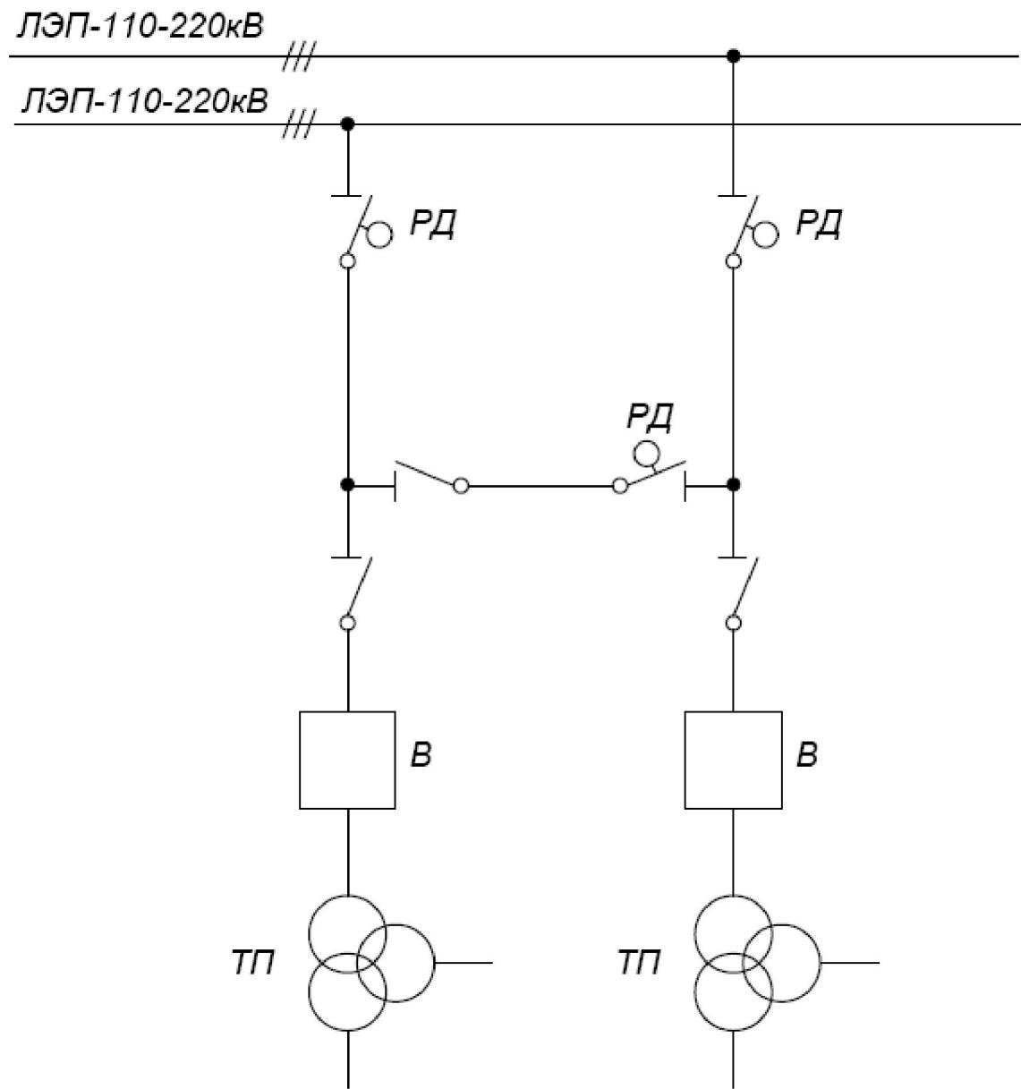
**Рис. 2 – Схема подключения отпаечной тяговой подстанции к сети высокого напряжения**
