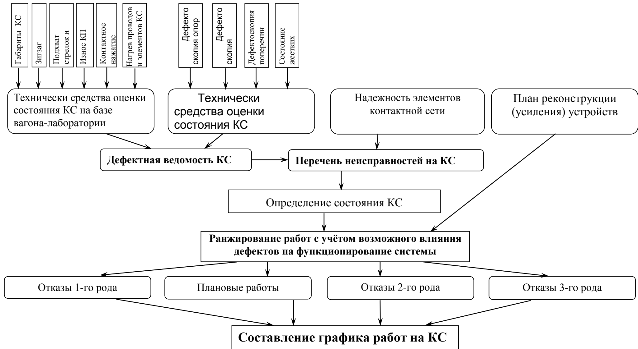
Рис. 3. Структурная схема определения фактического состояния КС и планирования работ
