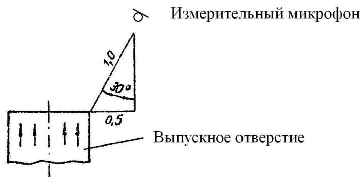
Рис. 2 Расположение измерительного микрофона относительно выпускного отверстия
