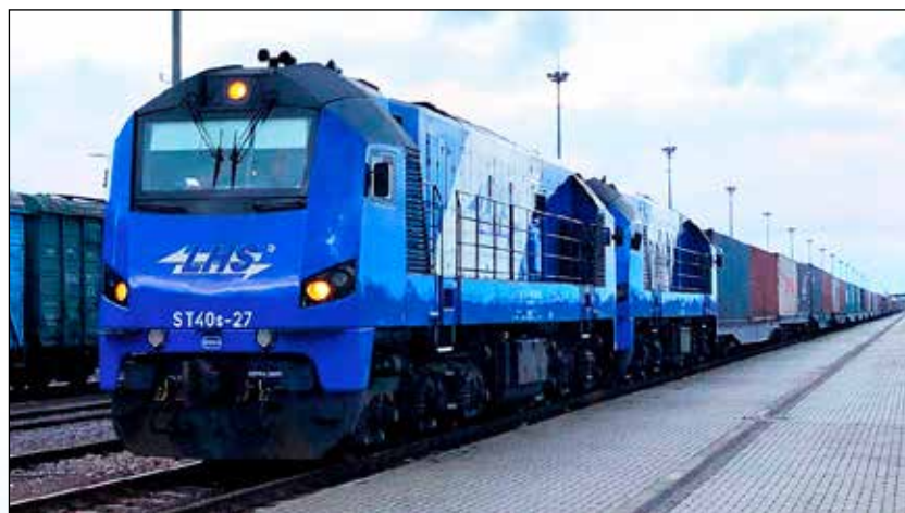
从中国出发的集装箱列车经波铁宽轨冶金线公司的1520mm轨距铁路入境波兰，无需换装
