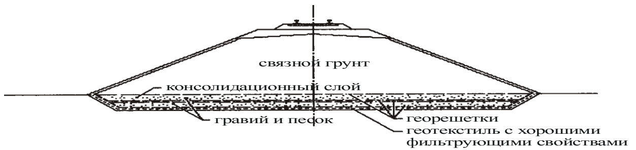
а) укладка насыпи на подушке из гравия и песка
