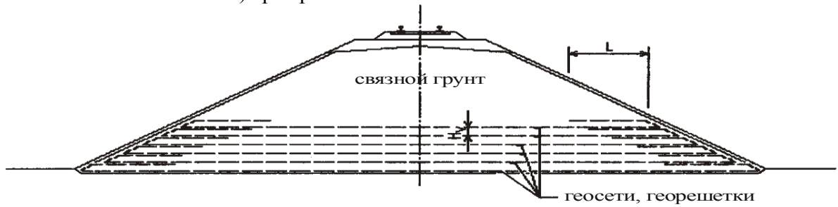
а) армирование насыпи геосинтетиками
