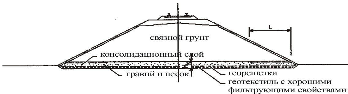
в) консолидационный слой с захваченным армирующим геосинтетическим материалом
