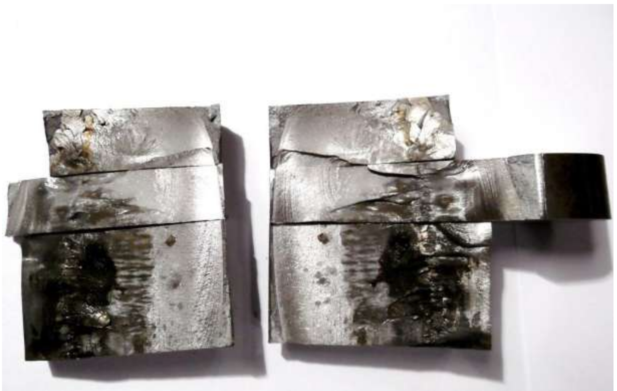
Рис. 13. Вскрытая продольная трещина хвостовика крестовины стрелки.
