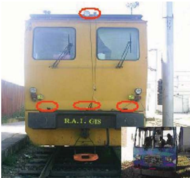
Рис. 4. Расположение цифровых камер на дрезине
