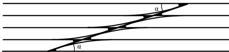
Рисунок 18 – Схема стрелочной улицы промежуточной
