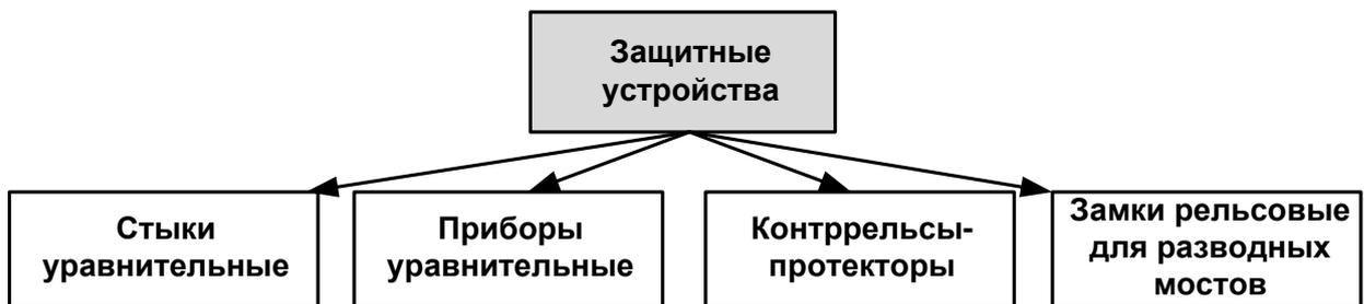
Рисунок 31 – Классификация защитных устройств
