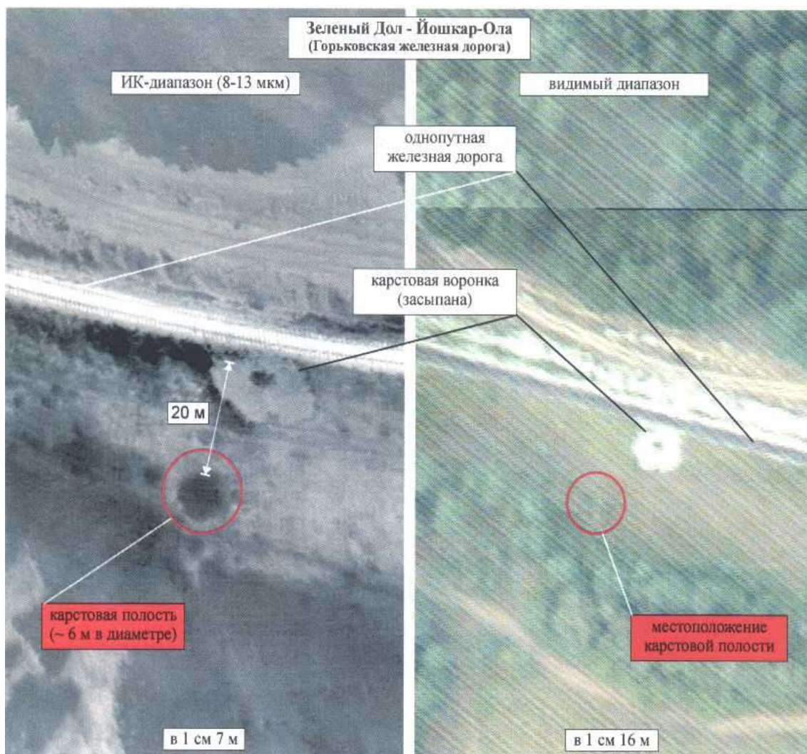
Рисунок 5. Диагностика карстоопасных мест с помощью инфракрасной фотосъемки
