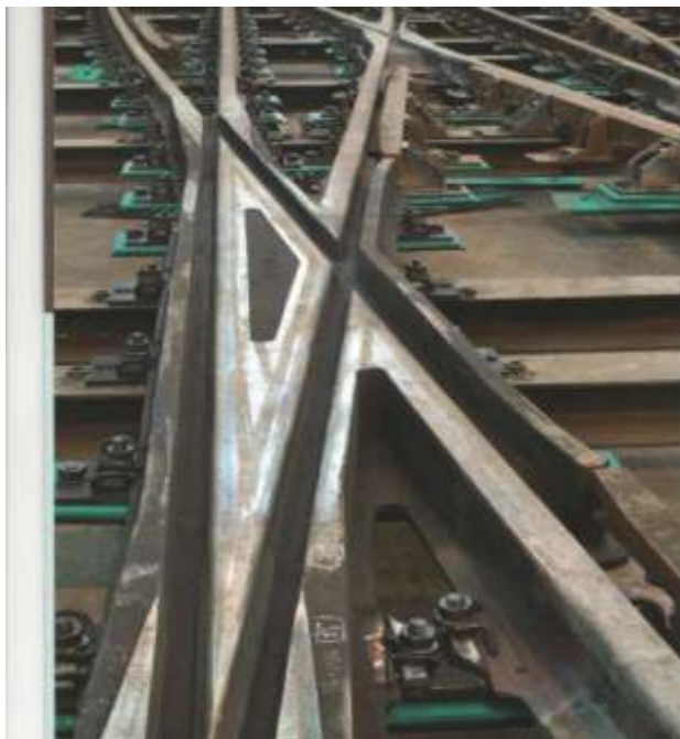
Рис. 9. Специальная конструкция цельнолитой тупой и двух острых крестовин.
