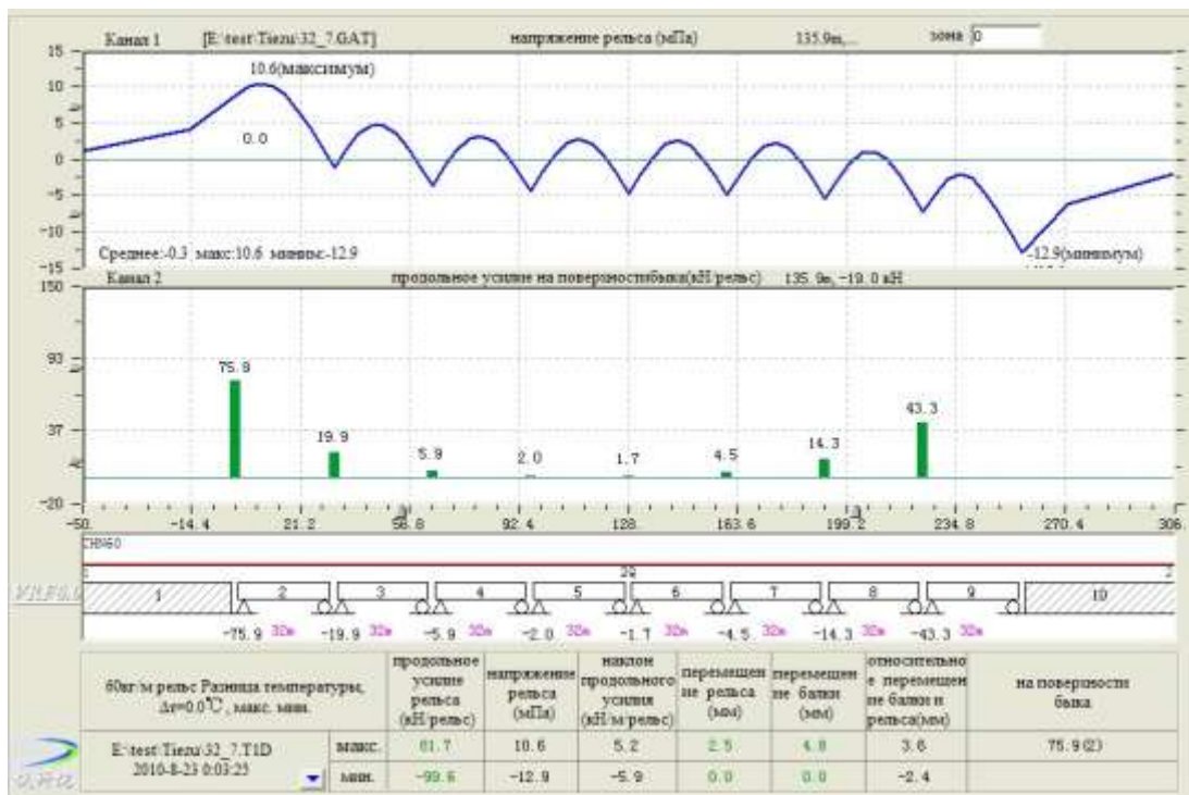
Рис.2-2 Распределение напряжений рельса и усилий растяжения-сжатия T1, приложенных на опорах и устоях.
