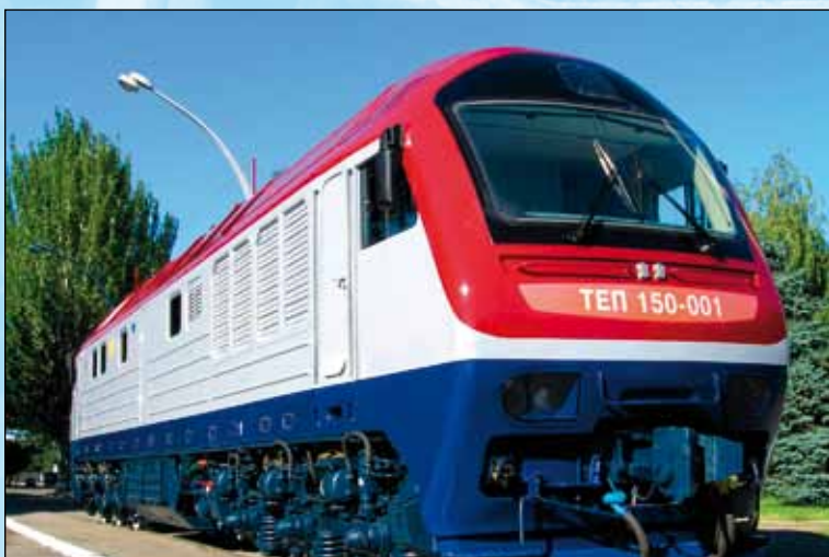
ТЭП 150 - магистральный шестиосный пассажирский тепловоз с электрической передачей производства Луганского тепловозостроительного завода на железных дорогах Украины
