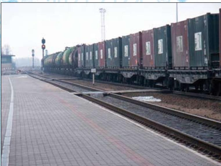
Поезд на станции Шауляй (Литовские железные дороги ЛГ), ширина колеи 1520 мм
