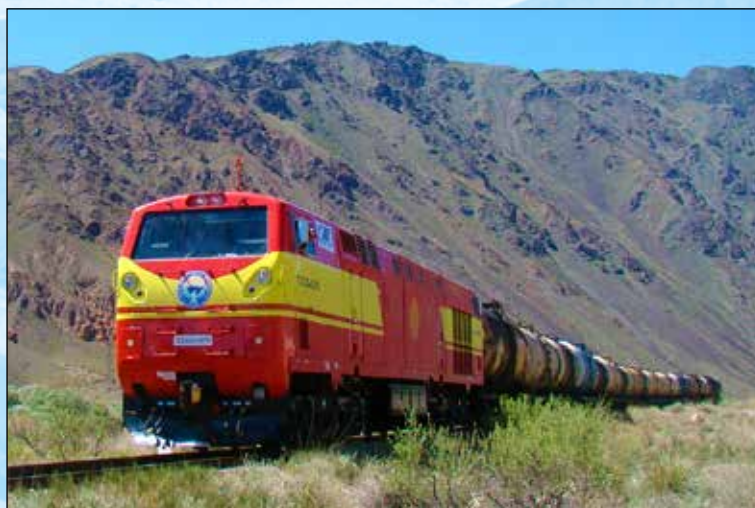
Поезд, ведомый тепловозом серии ТЭ33А «Evolution» ГП «Национальная компания "Кыргыз темир жолу"»
