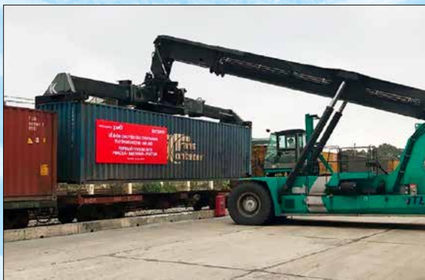
Погрузка контейнера на платформу для оправки в прямом железнодорожном сообщении Россия – Вьетнам
