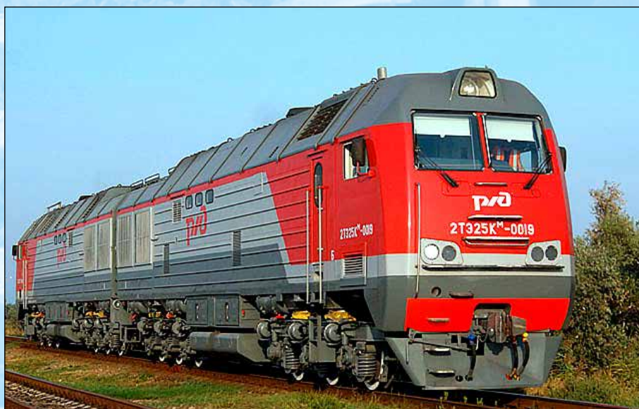
Двухсекционный тепловоз 2ТЭ25К «Пересвет» (Российские железные дороги)
