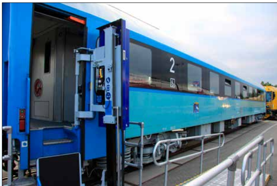
保加利亚铁路上的新型旅客列车与无障碍设施
