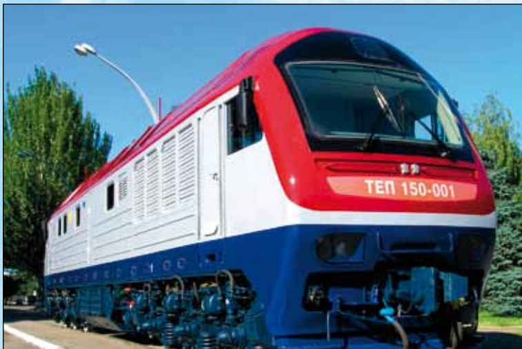
乌克兰铁路卢甘斯克内燃机车制造厂生产的 ТЭП150型电力传动六轴干线客运内燃机车
