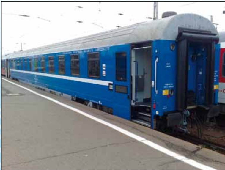
运行于明斯克—阿姆斯特丹的新型RIC限界客车(白俄罗斯铁路—白铁)
