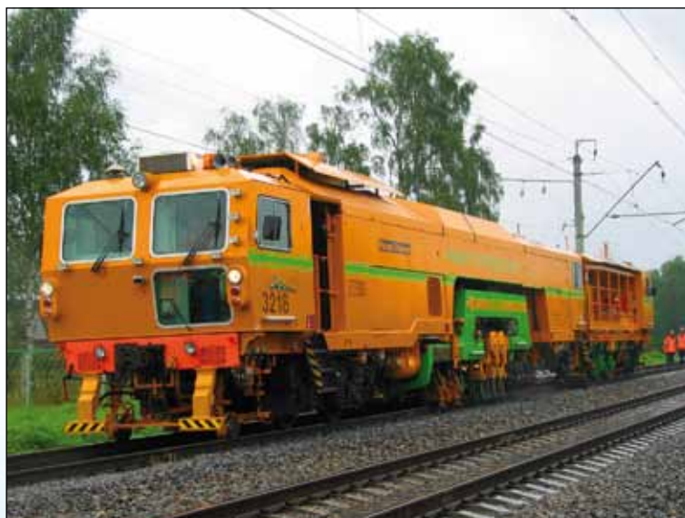
奥地利普拉塞和陶依尔公司（铁组加入企业）生产的线路维修技术装备
