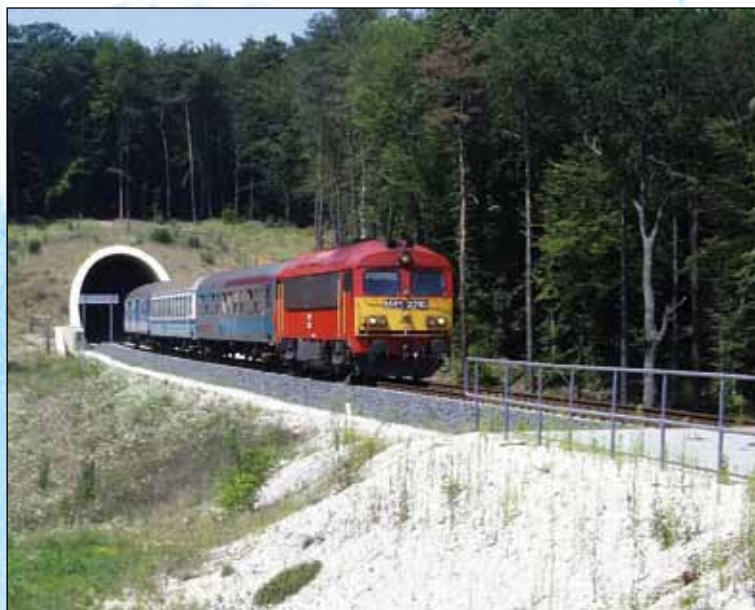
Тепловоз серии М41 с поездом «IC Citadella» по маршруту Будапешт (Венгрия) – Любляна (Словения)
