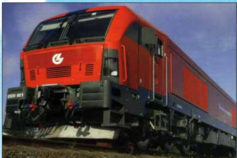
立陶宛铁路上运营的“西门子”公司生产的ER20CF-《Eurorunner》货运内燃机车
