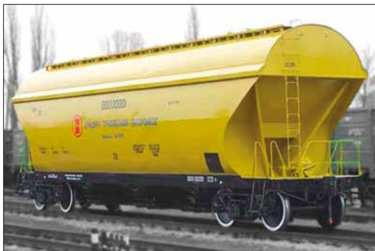
组件式1520mm轨距19-7016型 防雨粮谷和其它散装货物漏斗车（乌克兰）
