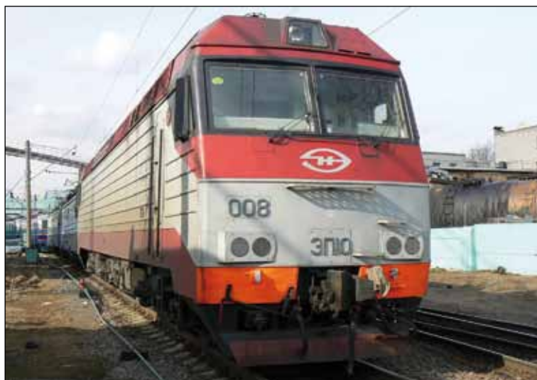
俄罗斯与Bombardier公司共同生产的 ЭП10型双制式客运电力机车
