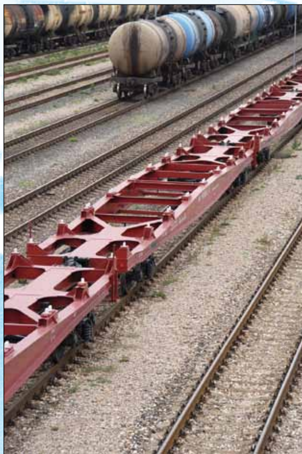
国内运输及与铁组成员国国际联运中采用的1520mm轨距新型集装箱平板车（拉脱维亚铁路）
