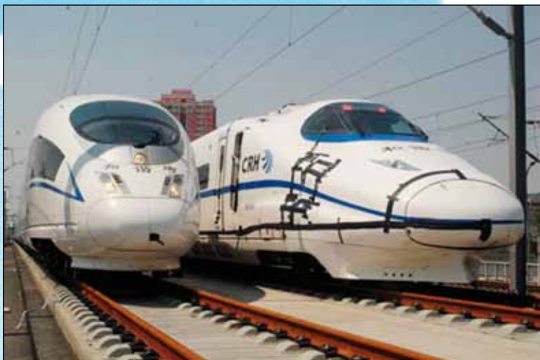
中铁在京津城际高速铁路上开行的 时速达350km的CRH系列高速电动车组
