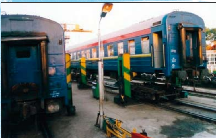
罗铁布加勒斯特——基希讷乌33次列车在温格内车站进行换轮作业
