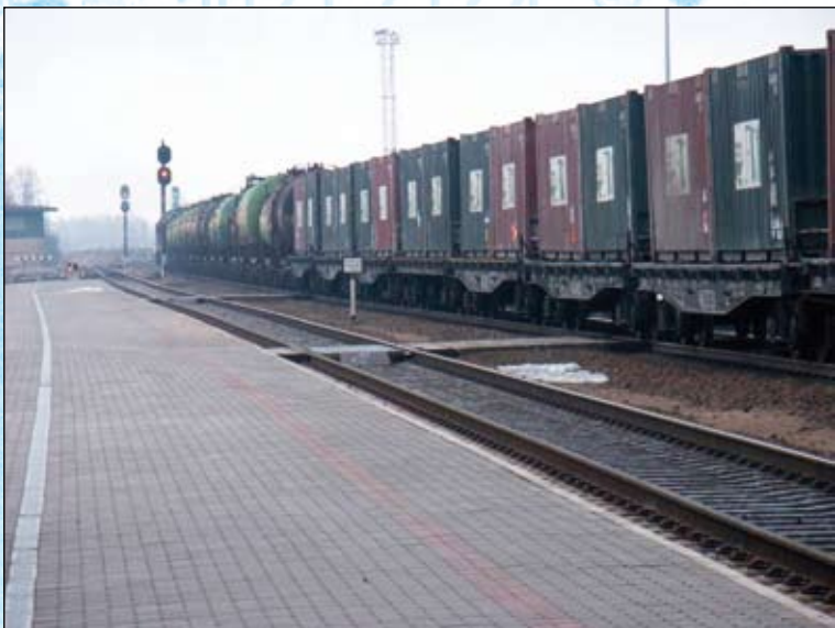
停靠在立陶宛铁路沙乌利亚伊车站1520mm宽轨线路上的列车
