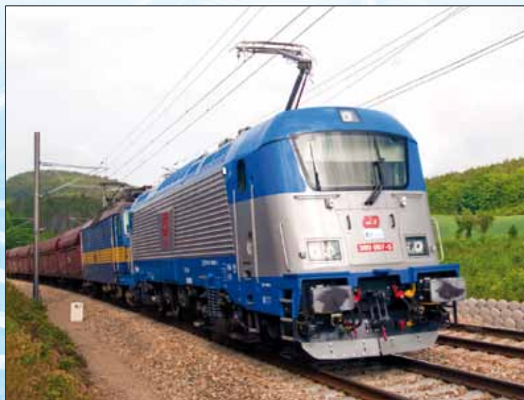
Die neue Multisysteme Elektrolokomotive Skoda 109E für Mehrzweckanwendung (CD, Tschechische Republik)
