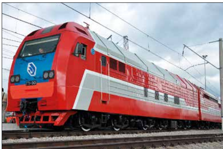
俄罗斯铁路的GT-1型燃气涡轮机车
