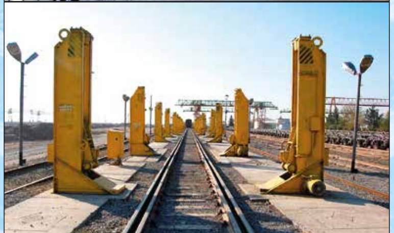
边境上的换轮站: 上图—白俄罗斯-波兰边境换轮站, 下图—土库曼斯坦-伊朗边境换轮站
