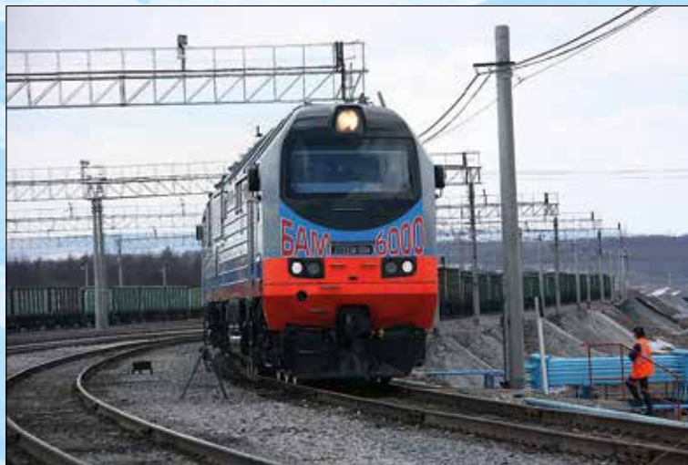
Двухсекционный тепловоз 2ТЭ25А Витязь с асинхронным тяговым приводом на Байкало-Амурской магистрали (Россия)
