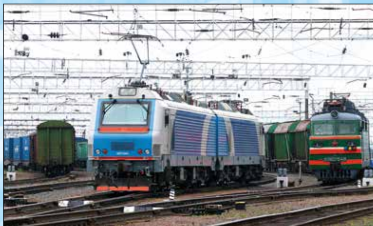
Двухсекционный грузовой электровоз БКГ1 китайского производства для Белорусской железной дороги
