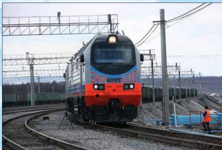
行驶在贝加尔-阿穆尔干线上的采用异步牵引传动装置的2ТЭ25А型“勇士”号双节式内燃机车（俄罗斯）
