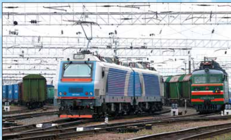
行驶在白俄罗斯铁路线上的中国制造的BKГ1型双节式货运电力机车
