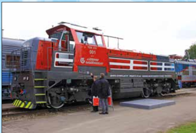
为立陶宛铁路生产的TEM LTH型四轴内燃调车机车
