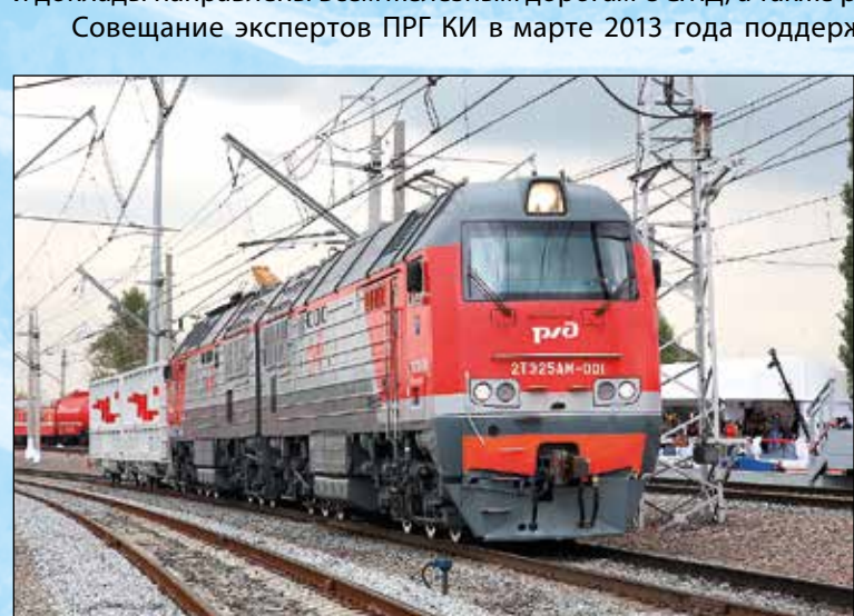
Новый двухсекционный тепловоз 2ТЭ25АМ «Витязь» с асинхронным тяговым приводом (Российские железные дороги)
