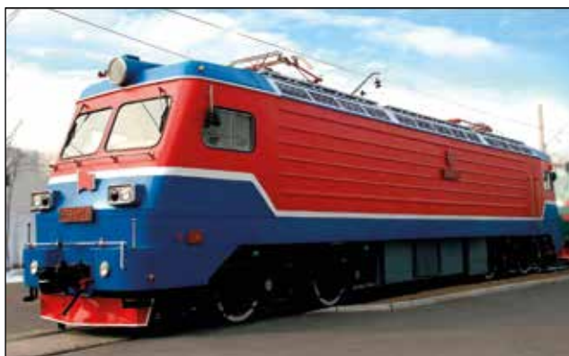
Электровоз переменного тока с асинхронным двигателем «Сонгунбулгунги-1» (КНДР)
