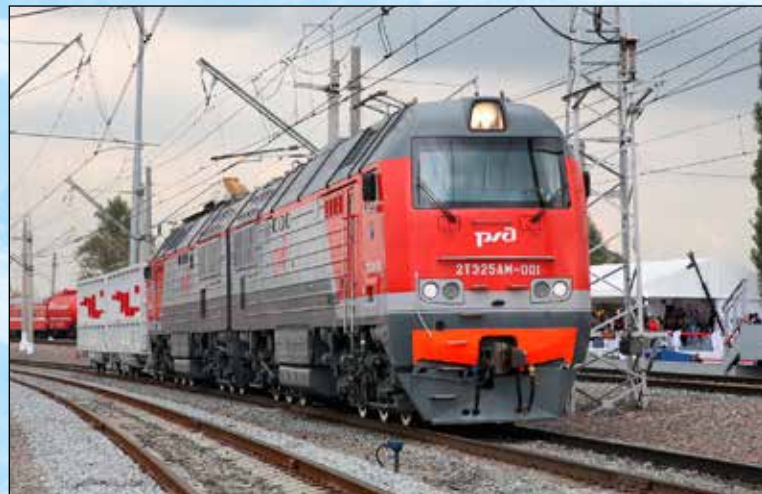
2T925AM型“勇士”号异步牵引传动双节内燃机车 （俄罗斯铁路）
