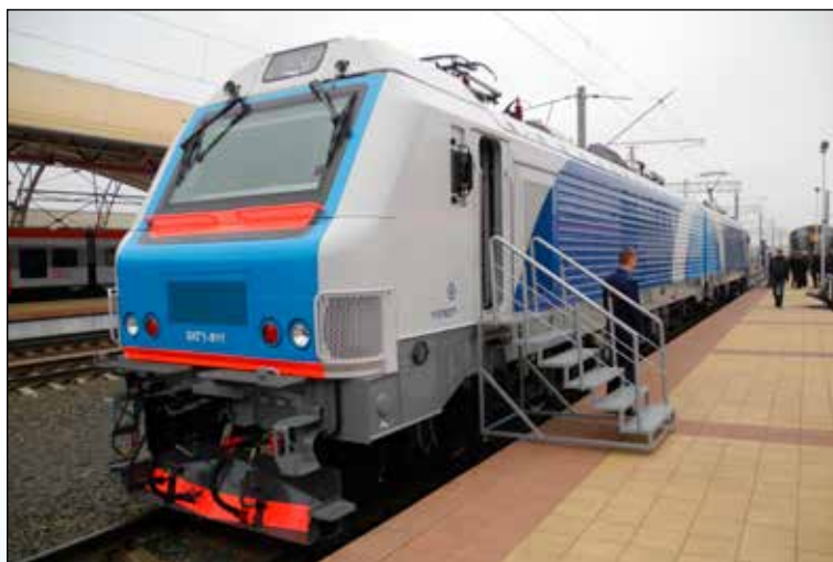
白俄罗斯铁路BKГ1型双节式干线电力机车
