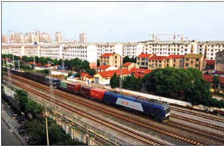
HXD1型电力机车牵引的集装箱列车（中国）
