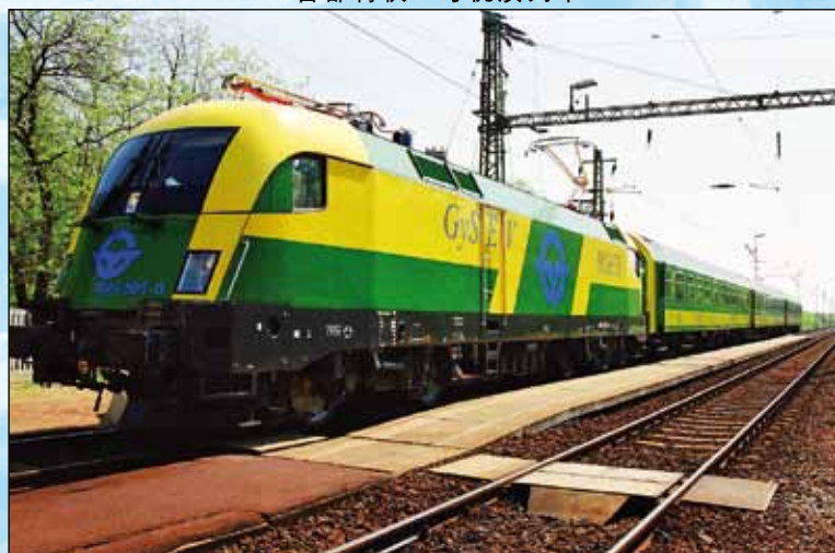
“西门子”为“古肖富”奥匈公司（铁组观察员）生产的ES64U2型电力机车
